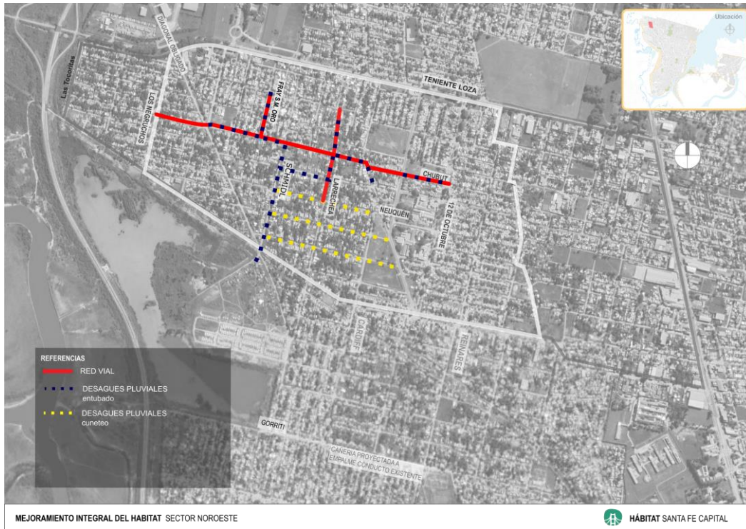
Imagen IV-10 – Proyectos obras desagües pluviales Área Central
